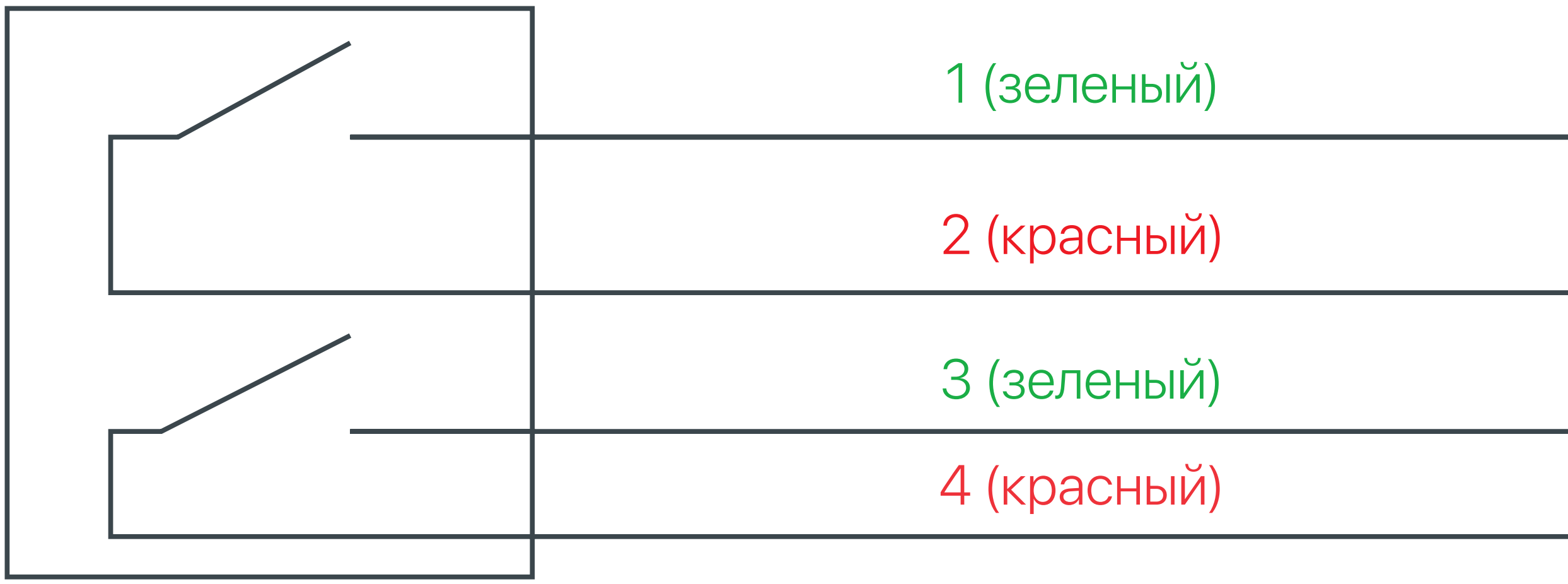
Рисунок 2. Схема подключения сигнализатора давления.
